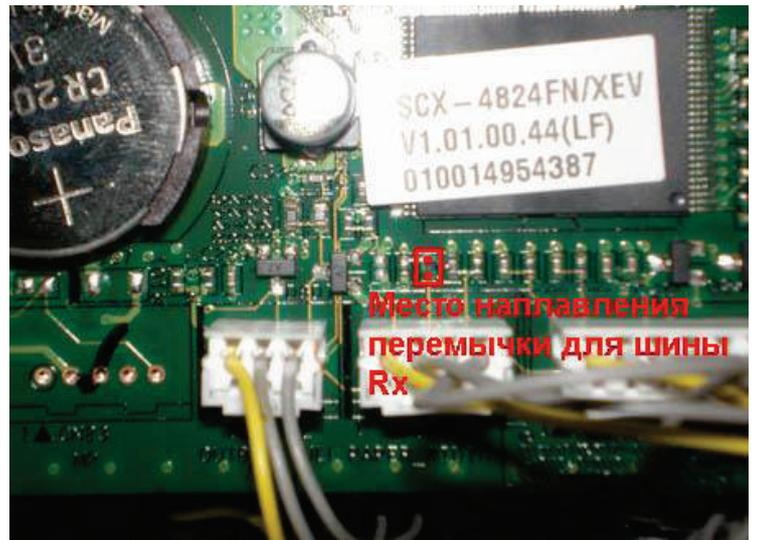
необходимо распаять шину Rx, чтобы была возможность отсылать команды по Debug-у. Делается это небольшим наплавлением двух контактов(если хотите наплавлением перемычки). Местоположение перемычки можно увидеть на фото. Мне нет необходимости рассказывать о Debug-e, потому как о нем уже много чего написано, а потому я могу перейти к рассмотрению флэш-памяти, где хранится серийный номер.
